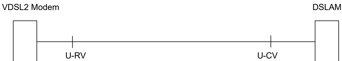
Abbildung 2.3.1 Schematische Darstellung eines VDSL2 FTTC Anschluss
