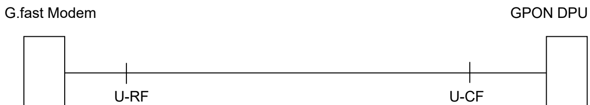
Abbildung 2.4.1 Schematische Darstellung eines G.fast FTTB Anschluss
